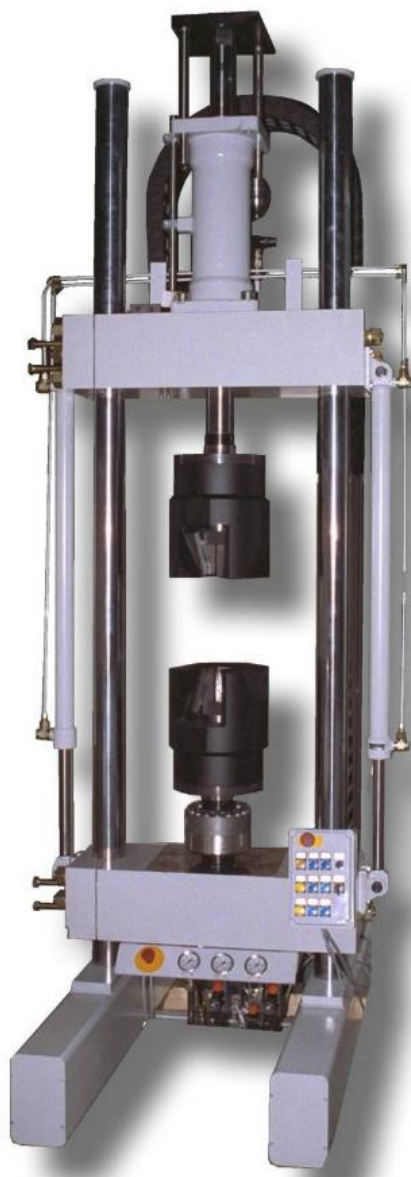
KUVIO 2. Servohydraulinen yleisaineenkoetuskone (Matertest 2005)
