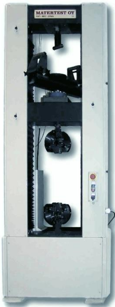
KUVIO 3. Tietokoneohjattu ruuvikäyttöinen yleisaineenkoetuskone (Matertest 2005)
