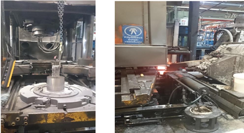
Kuvio 5. Vasemmalla puolella levypaketti alamuotin päällä ja oikealla puolella sulan alumiinin annostelu.
