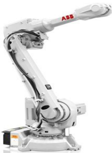
Kuvio 12. ABB:n valmistama kuuden vapausasteen kiertyvänivelinen robotti. /1/
