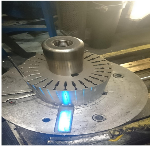
Kuvio 4. Tuurnalle ladottu roottorilevypaketti
