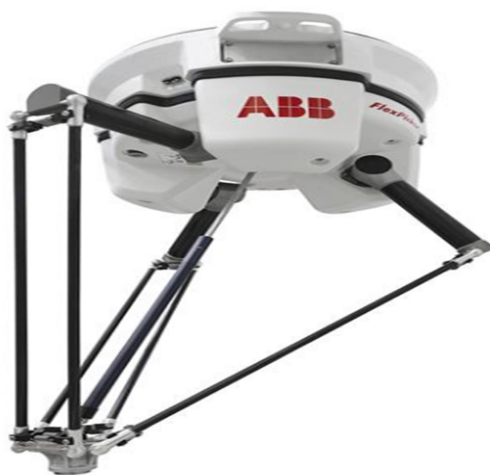
Kuvio 14. ABB:n valmistama rinnakkaisrakenteinen robotti. /1/
