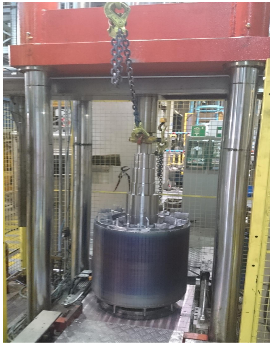
Kuvio 7. Akselin puristus roottoripakettiin
