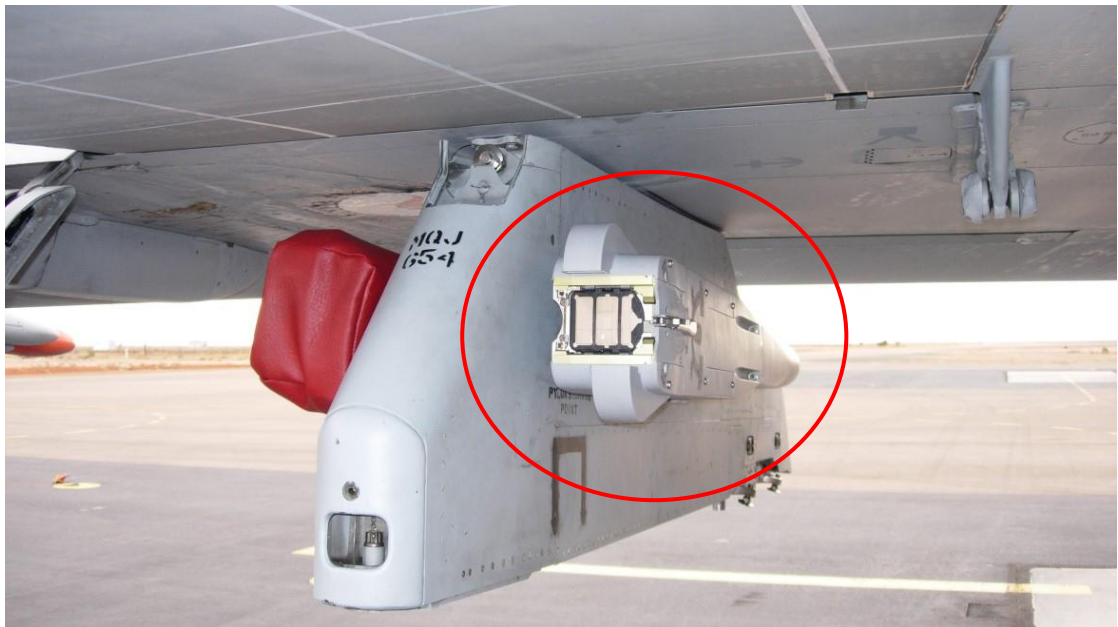
Kuva 8. BOL -omasuojaheitin Australian ilmavoimien F-18 –hävittäjässä. (BOL FOR F/A-18 ADVANCED COUNTERMEASURE DISPENSER)
