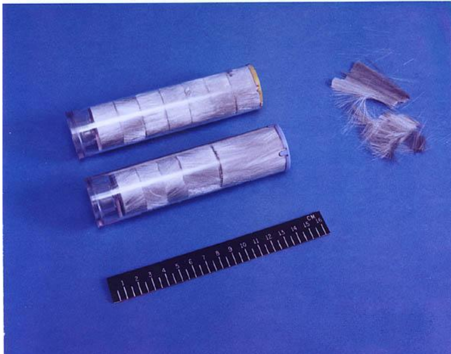
Kuva 5. Silppupatruunoita, joissa eri silppupituuksia. (US Navy Naval Research Laboratory, 2012)
