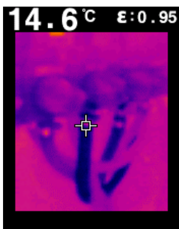
KUVIO 10. Lämpökuva jäähdytysjärjestelmän jakotukista (Wiitta Oy. 2016)
