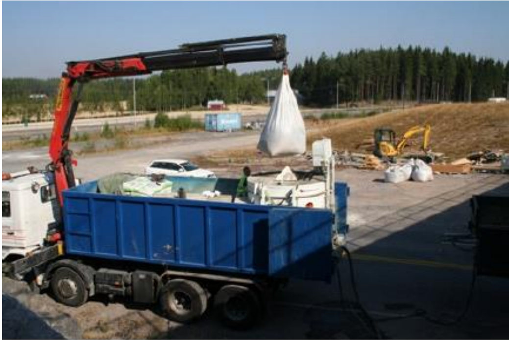
Kuva 2. Suomen Rakennelujitus Oy:n betoniasema kuorma-auton lavalla
