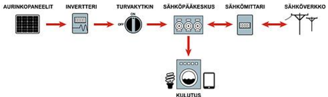
Kuva 8. Kaaviokuva aurinkosähköjärjestelmästä. (Motiva 2014).
