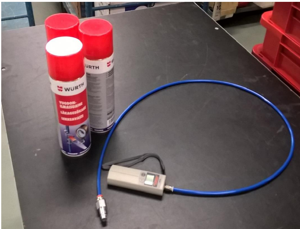
KUVA 11. Painemittari pikaliitinadapterin kanssa sekä vuodonilmaisuaaineet
