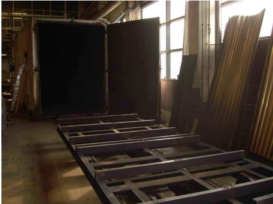
Kuva 8. Lämpökäsittelyuuni. Etualalla kelkka jolla puutavara työnnetään kiskoja pitkin uuniin.
