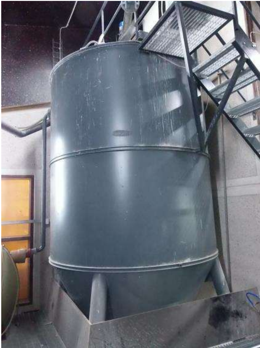
Kuva 9. Dekanteri eli hienon kiintoaineksen erotussäiliö.
