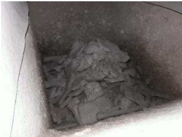
Kuva 13. Jätebetonista eroteltua hienoa kiintoainetta.
