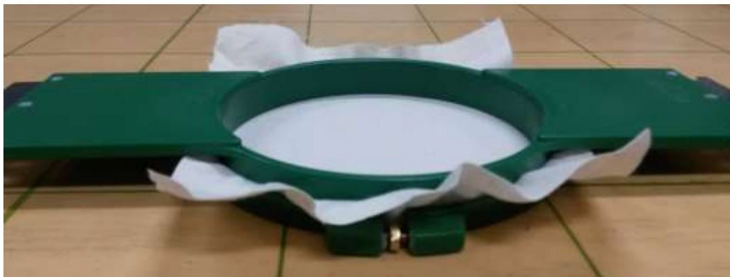
KUVA 4. Kankaan pingotus brodeerausraamiin.
