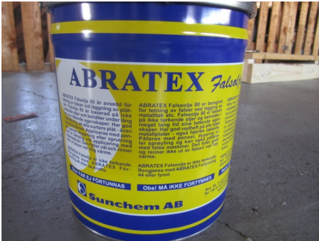
Kuva 9. Konesaumakatoilla tiivistysaineena yleisesti käytetty valssiöljy. (17.)
