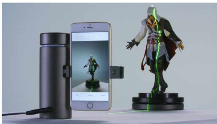
Figur 28. Företaget Eora 3D har utvecklat ett tillbehör till en smarttelefon med vars hjälp man kan 3D-scanna objekt med en app.(bild från företagets hemsida
