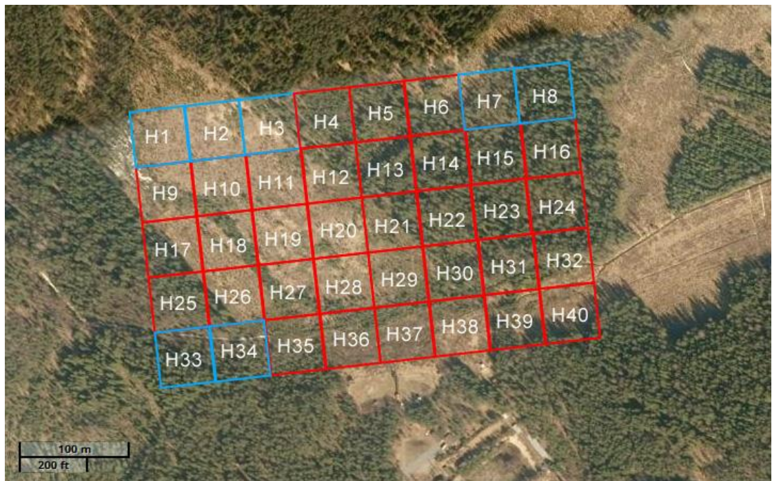
KUVA 7. Näytteenottoruudukko. Siniset ruudut ovat näytteenoton ulkopuolelle jätettyjä alueita (Kivistö 2015).
