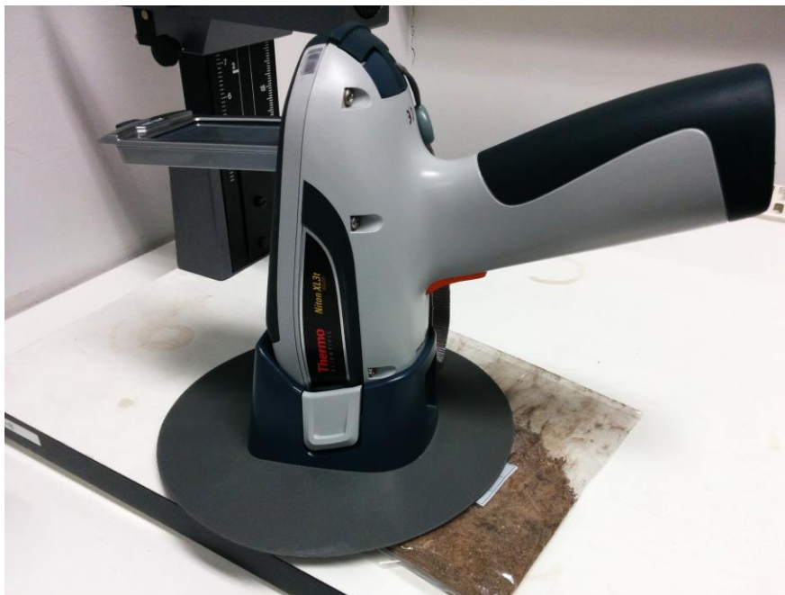
KUVA 8. XRF-mittaus maanäytteestä. (Kivistö 2015)
