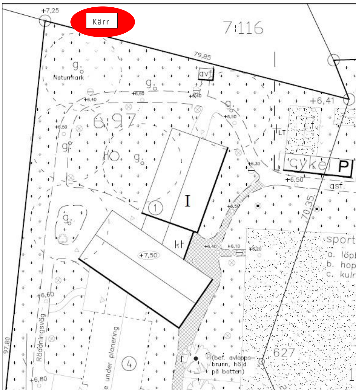
Figur 16. Ett kärr existerar nära byggplatsen och på en högre höjd jämfört med berggrunden under byggnaden.
