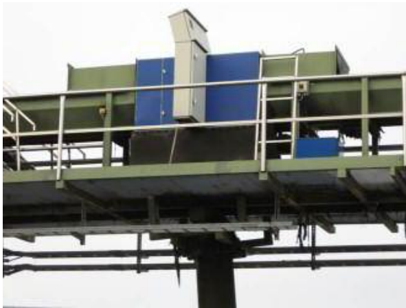
Kuva 4. Opmes-tukkimitari (Mikropuu Oy:n verkkosivu, [viitattu 02.10.2009])
