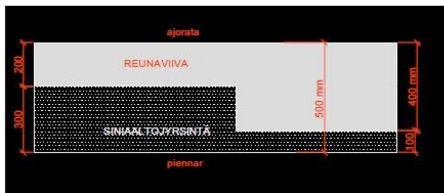
Kuva 19 Siniaaltojyrsinnän mitoitusohje
