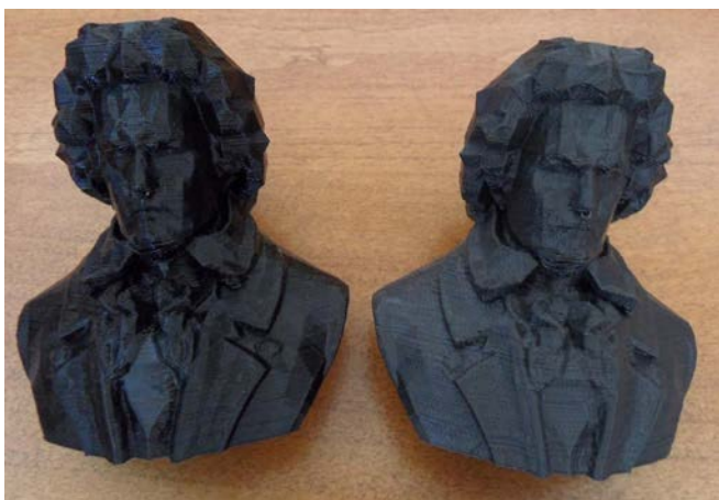
KUVA 8. Käsittelemättömien tulostuskappaleiden eroavaisuus. Vasemman puoleisen kappaleen materiaali on PLA ja oikeanpuoleisen ABS. (Lievendag 2014.)
