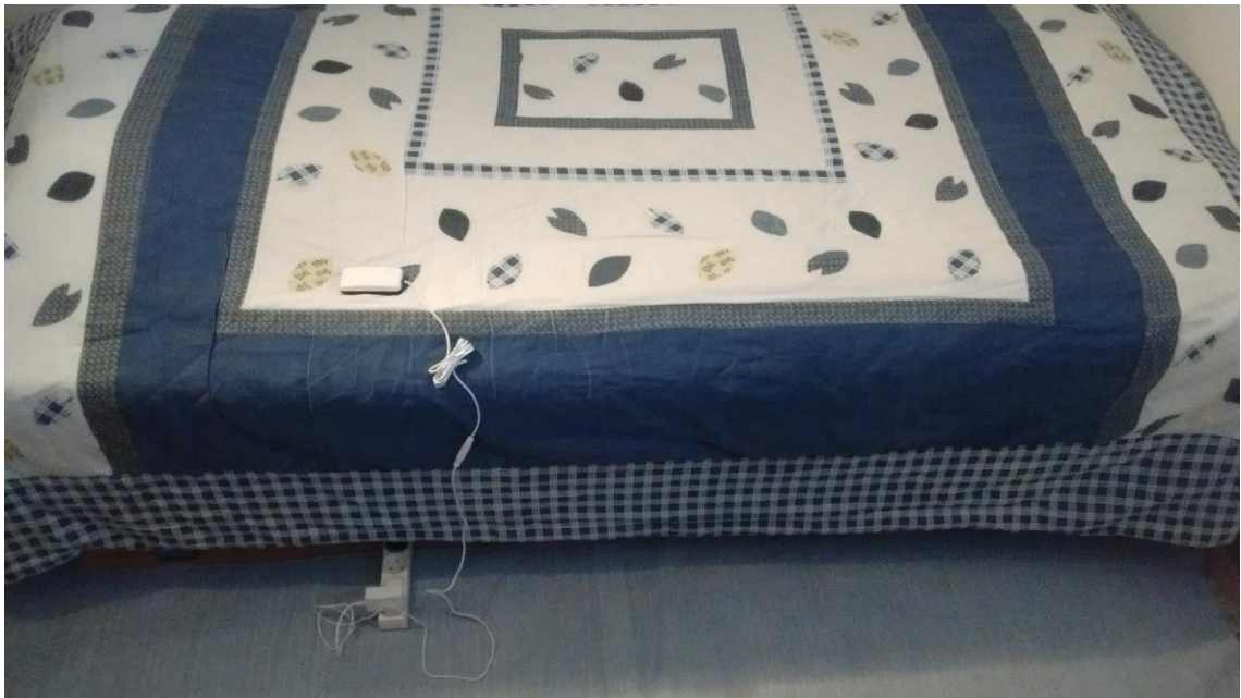
Kuva 17. Anturi asennetaan yhdensuuntaisesti henkilön makuuasennon kanssa.
