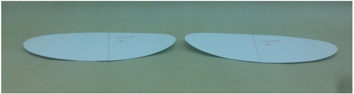
Kuva 53. Päälystämättömät rinnakkaiset näytteet, KP1, RH 70 % (1.)
