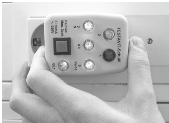
(Kuva 1) Pistorasioiden testaus Testavit-Shuki koestimella. Merkkivalojen syttyminen kertoo, että pistorasiaan tulee virta. Valojen tietty yhdistelmä kertoo kytkentöjen olevan oikein.
