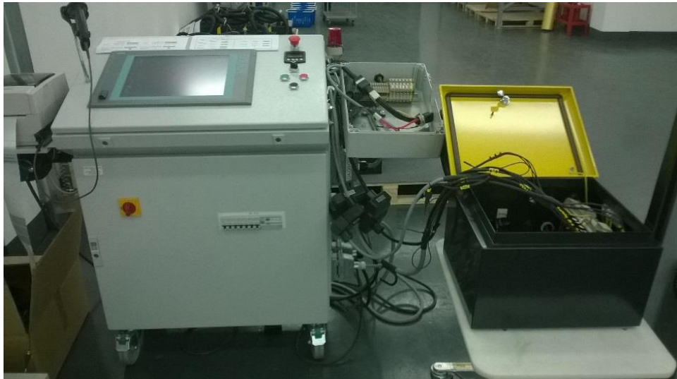
Kuva 10. Nostimen kojekaapin liittämistä testilaitteeseen
