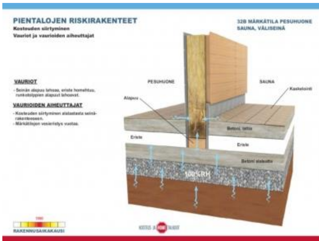
Kuva 1. Pesuhuoneen seinärakenne. (Hometalkoot.fi, [Viitattu 18.9.2015].)
