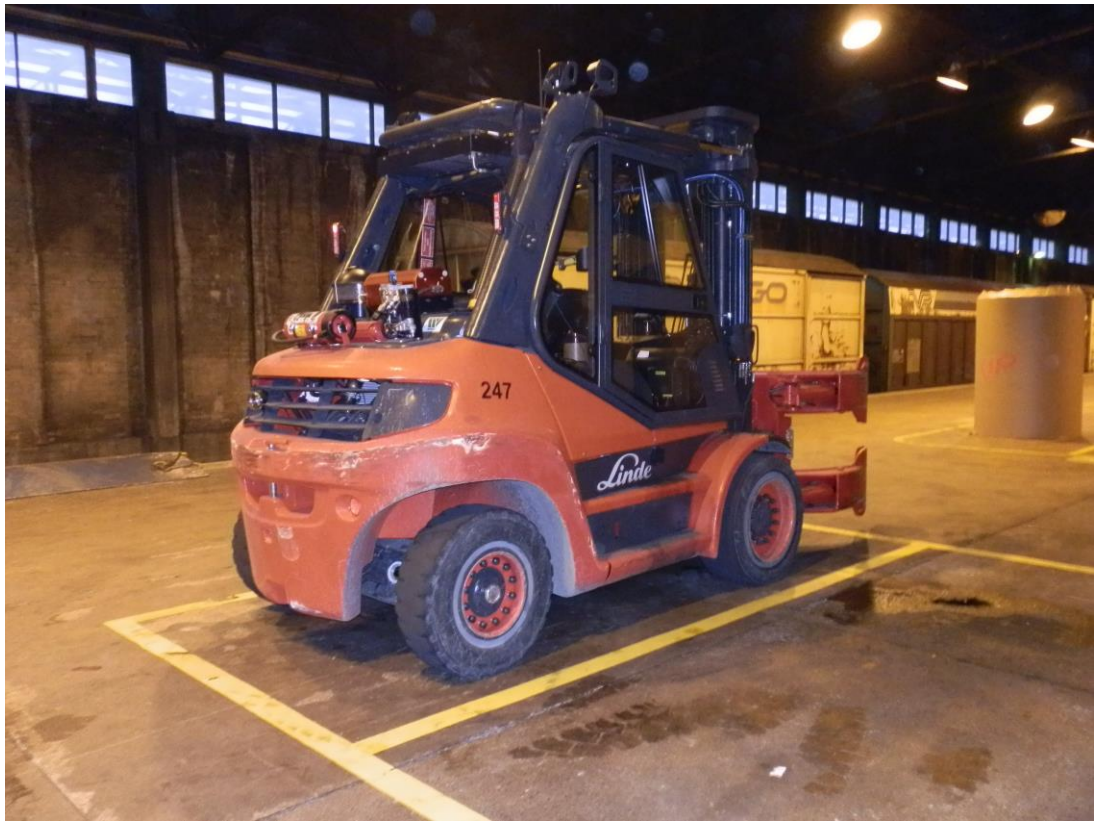
Kuva 7. Tyypillinen trukki, nostomasto ja tartuntapihdit paperirullien käsittelyä varten
