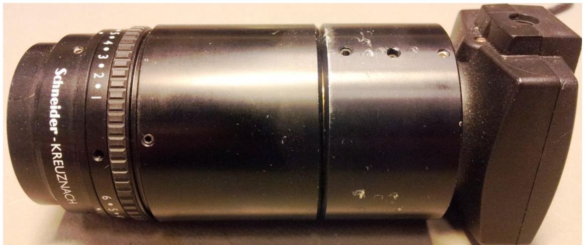
Kuva 10. Schneider 2.8/28 Makro-linssi 66 mm loittorenkailta.
